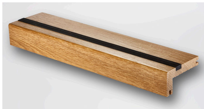
Treppenkante aus Massivholz Eiche 1. Qualität matt lackiert, Dimension 60/30 mm, Winkel 90°, Stärke 10 mm, beidseitig genutet, Gummigleitprofil schwarz, 10 mm
