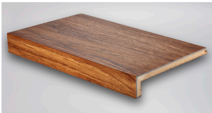
Vinyl-Treppenkante aus bauseitig geliefertem Vinyl-Belag Belagstärke 10 mm, Dimension 157/31 mm, Winkel 90°, mit Abschluss unten, 2x eingeschlagen
