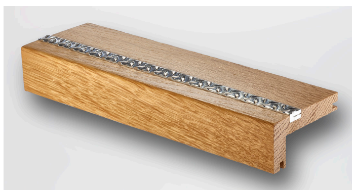
Treppenkante aus Massivholz Eiche 1. Qualität matt lackiert, Dimension 60/30 mm, Winkel 90°, Stärke 11 mm, beidseitig genutet, Gleitprofil aus Riffelblech, 10 mm
