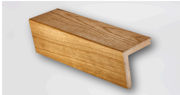
Treppenkante aus angeliefertem Eichenparkett Dimension 62/62 mm, Stärke 10 mm, mit angezogenem Winkel 82°, oben mit Nut, unten mit Kamm
