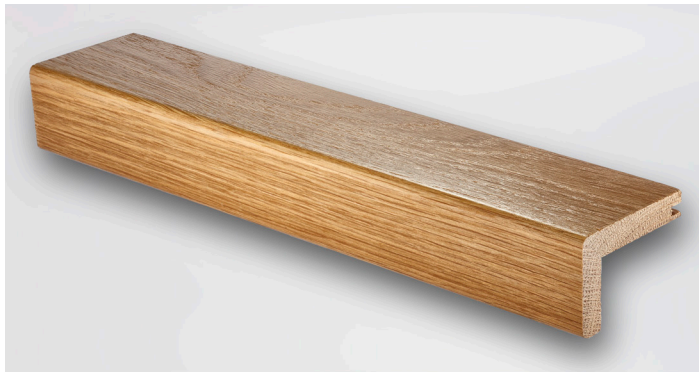
Treppenkante aus Massivholz Eiche 1. Qualität lackiert, Dimension 60/40 mm, Winkel 90°, Stärke 11 mm, oben genutet, unten mit Abschluss leicht gerundet
