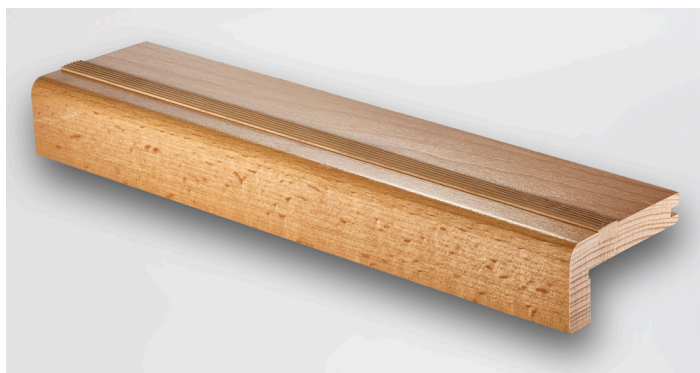
Treppenkante aus Massivholz Buche gedämpft matt lackiert, Dimension 60/30 mm, Winkel 90°, Stärke 11 mm, oben gerundet, unten mit Abschluss, Gummigleitprofil beige, 10 mm
